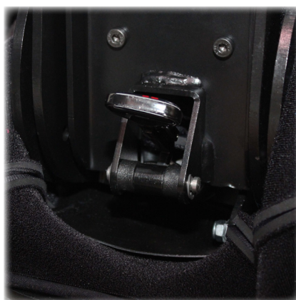
Utløerspak for regulering av hoftevinkel
