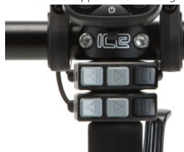
Di2 kontrollknapper for elektrisk gir
